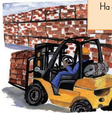
Diboloko tsa letsopa di a omiswa. Dikotwana tsa letsopa le ommeng di beswa ho sebopi sa ditena.
