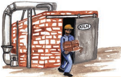
Diboloko tsa letsopa di a omiswa. Dikotwana tsa letsopa le ommeng di beswa ho sebopi sa ditena.
